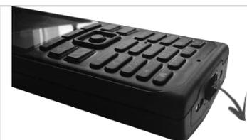
Brancher directement le câble USB sur votre téléphone. L'autre extrémité du câble USB peut être raccordée à l'adaptateur AC/DC ou à une prise USB d'un ordinateur par exemple.
